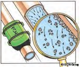
Na montage van de Alpine Waterdescaler No. 1® laat de oude kalklaag los en vergruist.
